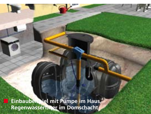
■ Einbaubeispiel mit Pumpe im Behälter, Regenwasserfilter extern
