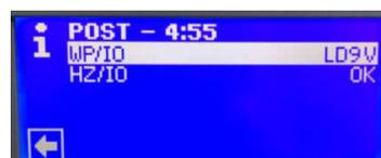
3.1a) Wenn die Verbindungsprüfung der **ThermoAura F 9 kW** nicht erfolgreich abgeschlossen wird und mehrere Minuten „Warte“ im Display steht, dann muss die Busverbindung von Inneneinheit zur Wärmepumpe überprüft werden, rosa Stecker, Belegung siehe Bilder.
